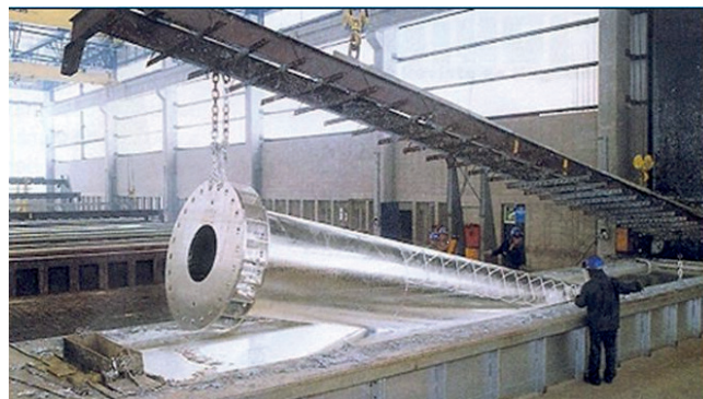
Processo de galvanização a fogo por batelada
