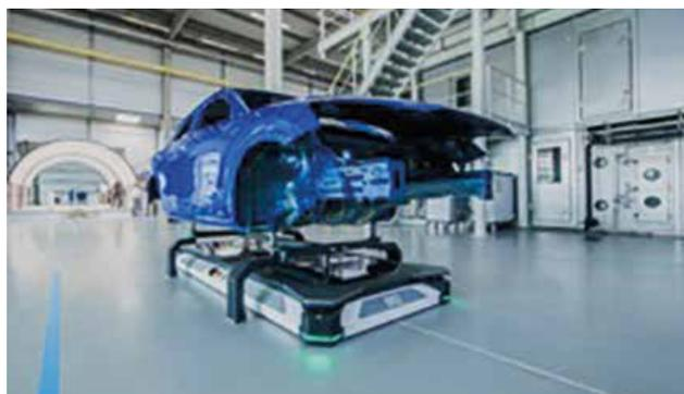
Adaptadores específicos fixam a carroceria e garantem uma entrega precisa à tecnologia do transporte de processo.
