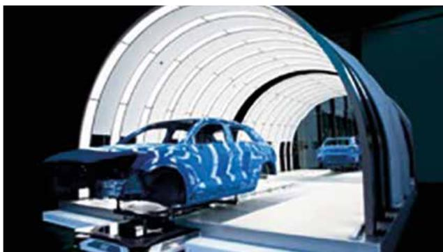
Perfeitamente coordenado: O transportador entra na inspeção de qualidade de superfície com a carroceria do carro e pode aproveitar o tempo de espera para recarregar.
