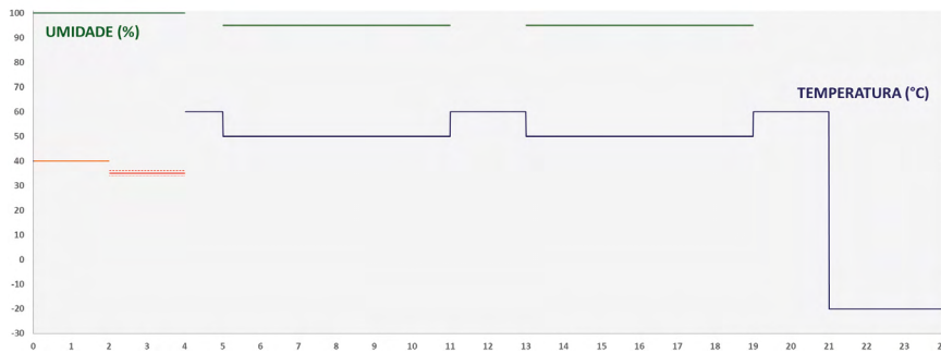
Figura 6: Temperatura e umidade relativa de um ciclo de ensaio conforme norma da indústria automobilística C
