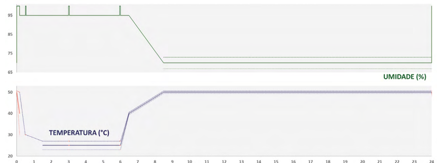
Figura 10: Temperatura e umidade relativa do 1º subciclo do ensaio conforme norma da indústria automobilística G
