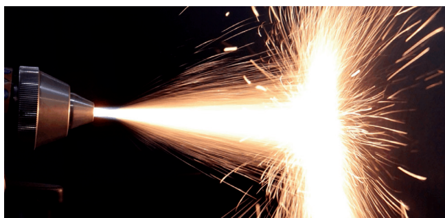
Metalização a arco elétrico (arc spray)
