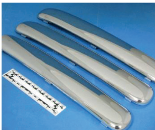
Foto 4: Exemplo de peças decorativas cromadas em processo totalmente livre de Cr (VI)
