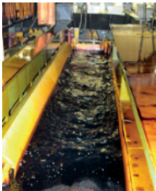
Foto 2: Exemplo de instalação de um banho 'condicionador' contendo ácido crômico na formulação, processo usado no pré-tratamento de plásticos
