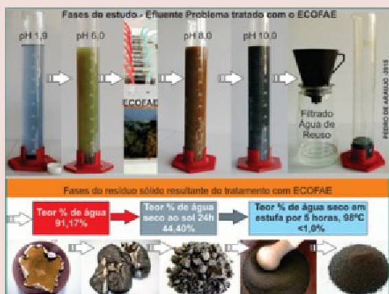
Figura 11 – Síntese do processo usado para mitigar o EP com ECOFAE
