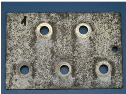
Figura 19: Área de contato do alumínio após 9 ciclos Ford L-467 parafusos: zinco alcalino + passivador + selante inorgânico reativo
