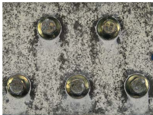
Figura 17: Zinco alcalino + passivador + selante inorgânico reativo, 6 ciclos Ford L-467, sobre a chapa de alumínio
