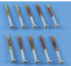
Figura 20b: Fosfato de zinco + 2x top coat prata
