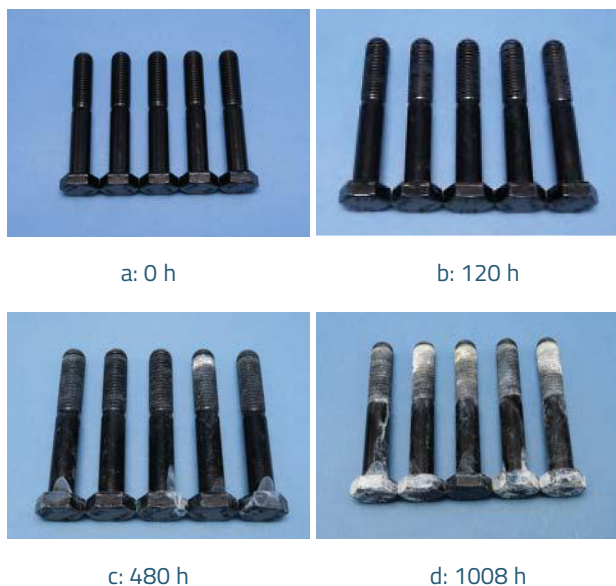
Figura 15: Zinco alcalino + passivador incolor + top coat (EN ISO 9227)
