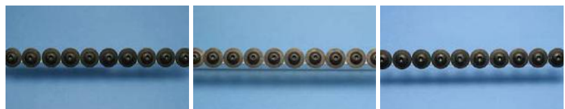
Figura 13 a: 24 h 150 °C, 0 h NSST (ISO 9227) Figura 13 b: 240 h NSST, sem alteração visual Figura 13 c: 1000 h NSST, sem corrosão vermelha
