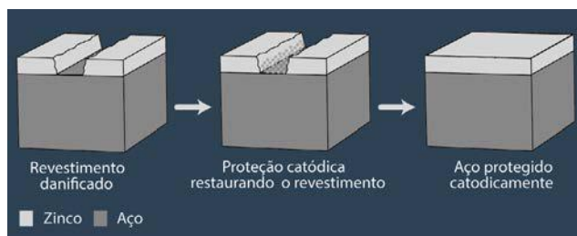
Figura: Proteção Catódica
