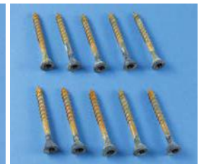
Figura 20c: Galvanizado a fogo, 8 ciclos
