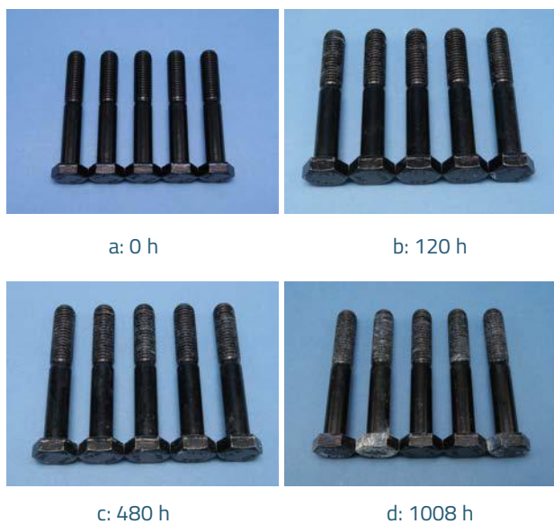
Figura 15: Zinco alcalino + passivador incolor + top coat (EN ISO 9227)
