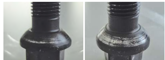
Figura 10: Parafuso após 20 montagens (aperto e desaperto), lado esquerdo passivado preto, lado direito passivado incolor
