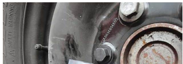
Figura 10: Parafuso após 20 montagens (aperto e desaperto), lado esquerdo passivado preto, lado direito passivado incolor
