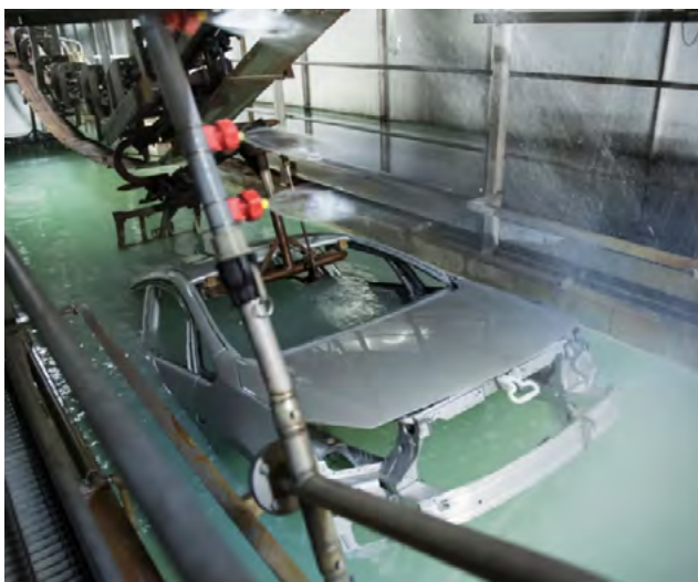
Figura 1 - Processo de fosfatização por imersão
