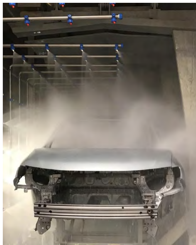
Figura 2 - Processo de fosfatização por aspersão
