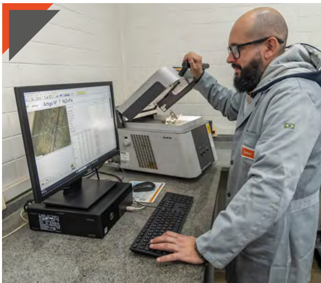
A Galrei conta com avançado equipamento de raios X para medição precisa da espessura de camadas, assegurando um rigoroso controle de qualidade e total conformidade com os padrões técnicos exigidos. Na imagem: Luis Alberto do Santos
