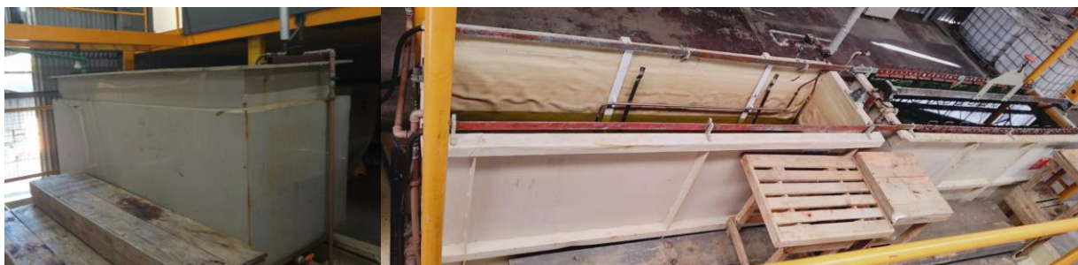
Figura 19 - Tanques reservas e desplaque
