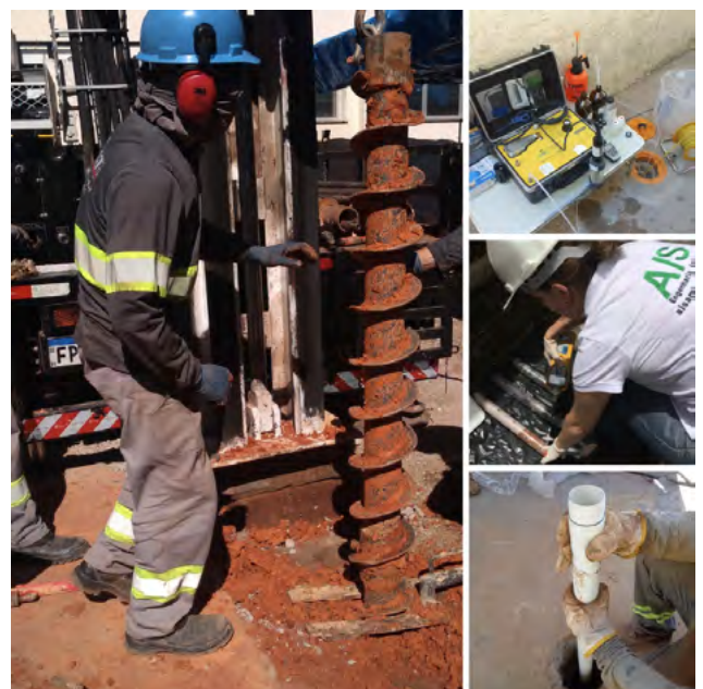
Figura 4: Coleta de amostras de solo e de água subterrânea
