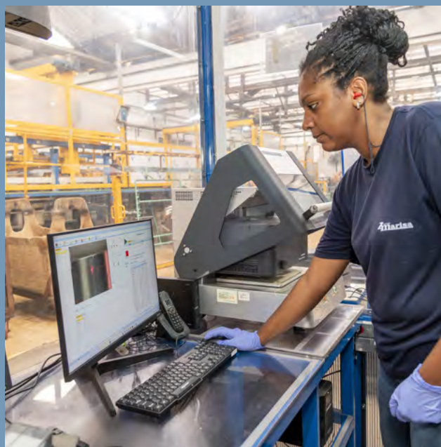
Inspeção por Raio-X para controle preciso da camada, garantindo a qualidade e conformidade das peças. Na imagem, a colaboradora Sabryne Queiroz
