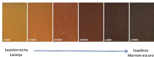
Figura 1 - Evolução da cor da pátina formada em amostras de aço patinável expostas na estação de corrosão do Instituto de Pesquisas Tecnológicas (IPT), na cidade de São Paulo, ao longo de 2 anos. Fonte: Travassos et al., 2019
