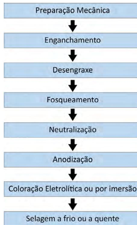
Figura 1: Fluxograma Geral de Processo de Anodização
