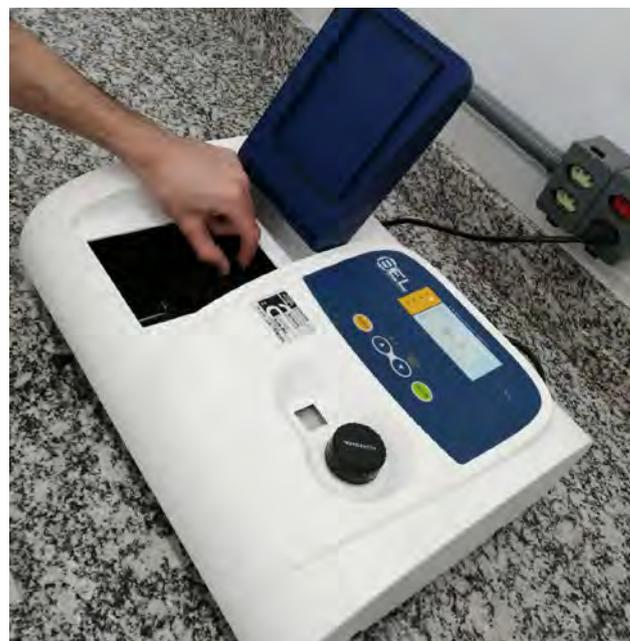
Espectrofotômetro usado para controle de qualidade de produtos com nanotecnologia
