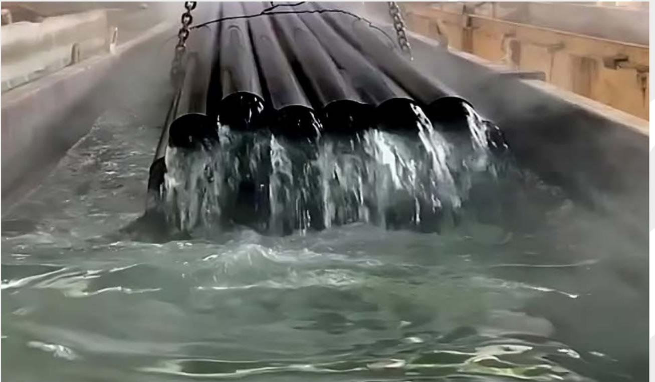
O **FOSFATIZANTE DREAM 3004** de alta performance é destinado à conformação mecânica a frio do aço, sua aplicação resulta em uma camada de fosfato de zinco microcristalina, formando base ideal para aplicação de lubrificantes. Sua formulação balanceada irá proporcionar um peso de camada entre 8 e 12 g/m<sup>2</sup>, de baixa rugosidade ideal para processo de conformação a frio de
